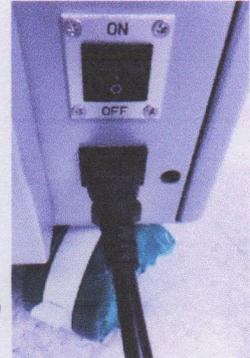
② No conecte el cable de alimentación a un tomacorriente de pared mientras el contacto de alimentación sea inestable.
